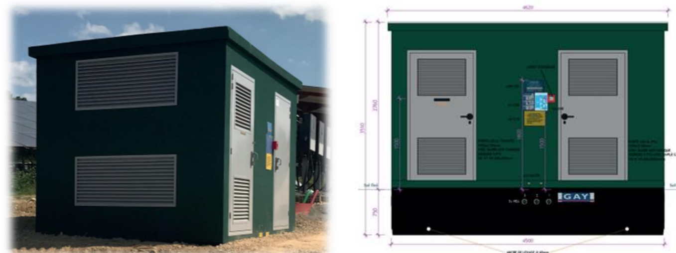
Figure 7: Coupes de principe et illustration des postes de transformation envisagés (Source : URBA 282)
