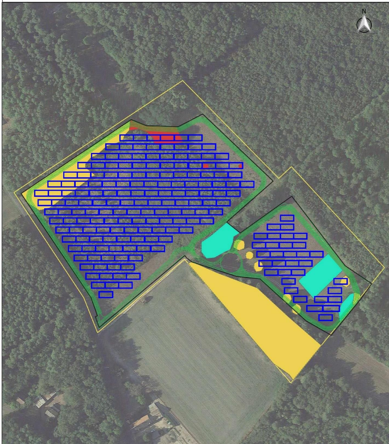
Plan de masse du projet photovoltaïque par rapport à la mise en défens des zones sensibles
